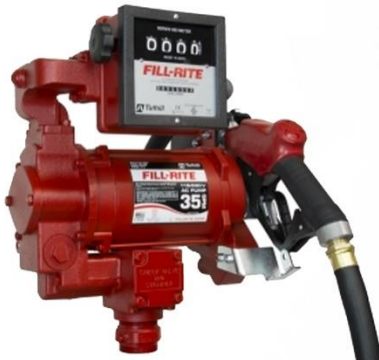
BOMBA ALTO FLUJO FR311VLB 115/230 VOLTS MOTOR 3/4 HP DESPACHO DE HASTA 113 LPM
