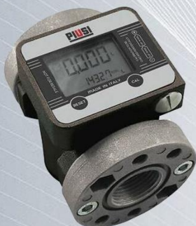
K600/3 F00496A40 MEDIDOR DE PULSOS 2.6 - 26 GPM 127 PULSOS POR GALON PRESION 426 PSI 1" NPT
